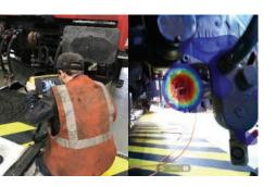
为了确保轨道行驶的安全,维护技术人员要特别注意制动系统。中央气动制动系统用于持续保持系统压力,并确保刹车片一直打开。一旦压力下降,制动器就会开始啮合,并对轮轴造成不必要的摩擦。压缩空气系统中的一个微小泄漏点就可能导致系统故障,从而启动制动器。必须尽快纠正这些错误。
