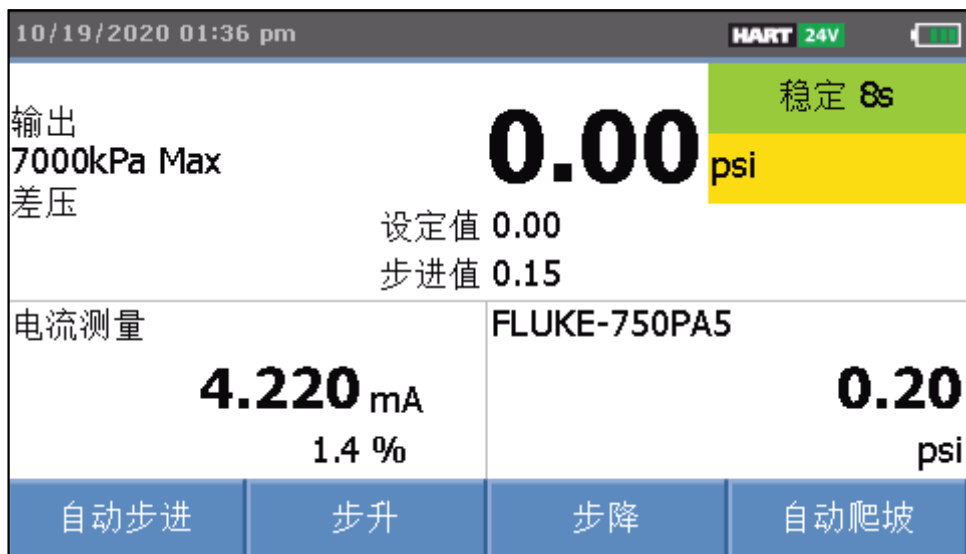
图示 3. 连接外置压力模块时的三重功能屏幕
