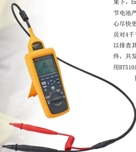
在本次例行巡检任务中，Emerson电池维护人员首先检查在线蓄电池监控系统的报警情况，发现有2节电池出现红灯报警。维护人员随后使用福禄克KUNLUN复查这两节报警电池并与同组的正常电池进行比较。测试结果发现，此2节电池内阻均超过 $4\text{m}\Omega$ ，而同组的正常电池内阻仅为 $1.5\text{m}\Omega$ 左右，内阻上升超过200%。在此测试结果下，Emerson维护人员确认2节电池严重劣化并建议灾备中心尽快更换。接着，维护人员对4千节电池进行目视巡检，以排查其中的漏液情况。最终，共发现漏液电池十余节，用BT510进行复查，确认均有不同程度内阻上升。维护人员随后进行标记并提示灾备中心注意观察。
