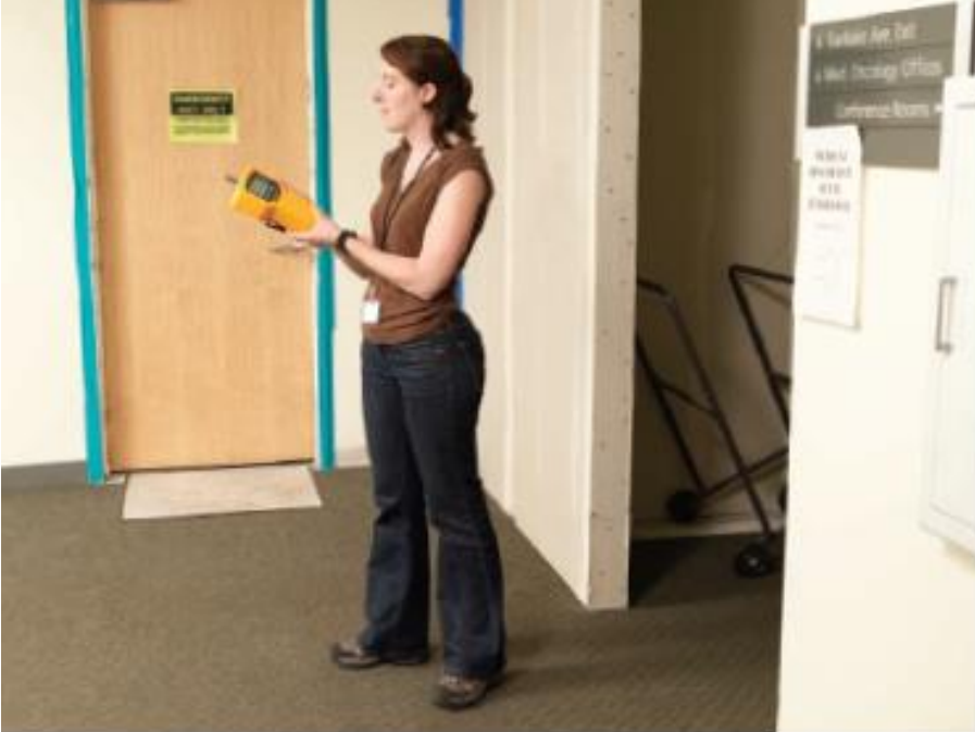
使用 Fluke 985 检测人居空间的尘埃粒子数量。
