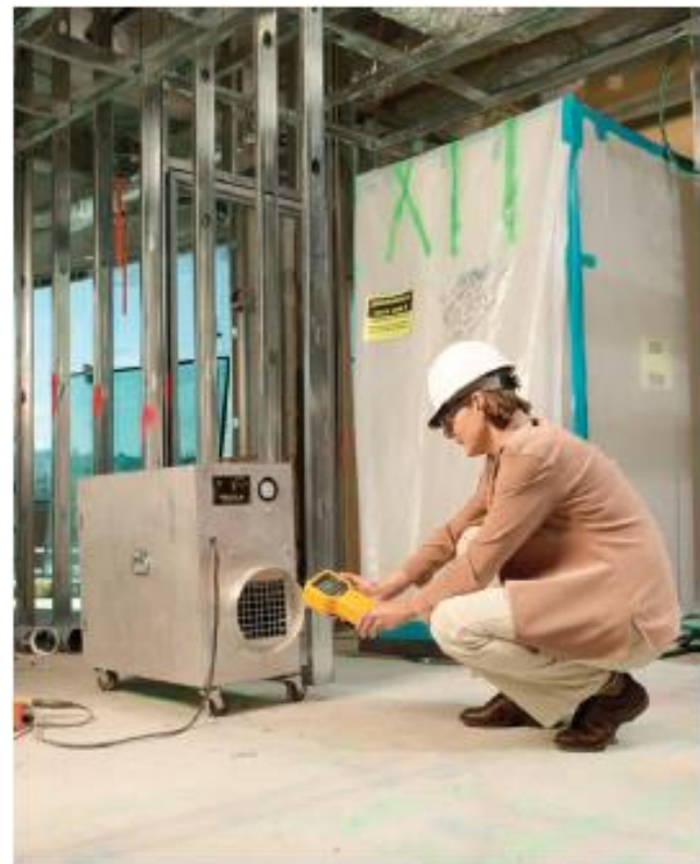
使用 Fluke 985 检查空气洗涤器新风中的粒子数量。
