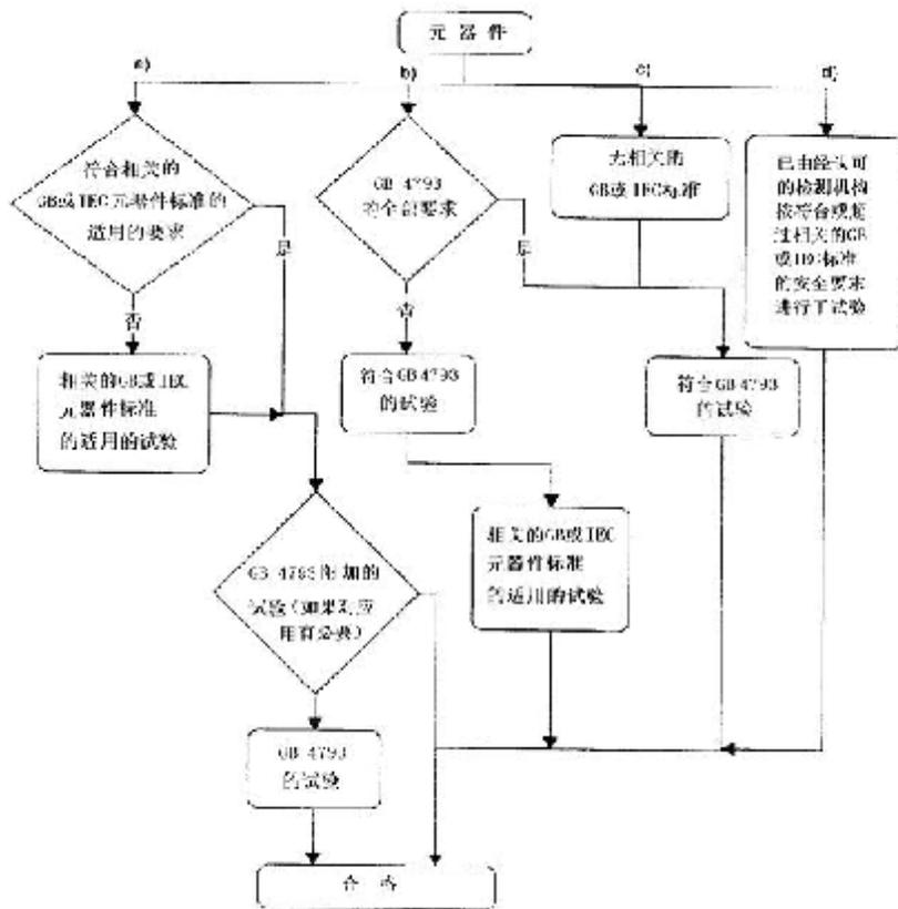
图10 符合性选项 14.1a)、b)、c) 和 d) 的流程图
