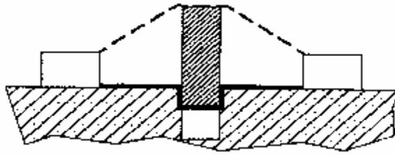
例 8 通过未粘合接缝的爬电距离小于越过挡板的爬电距离。
