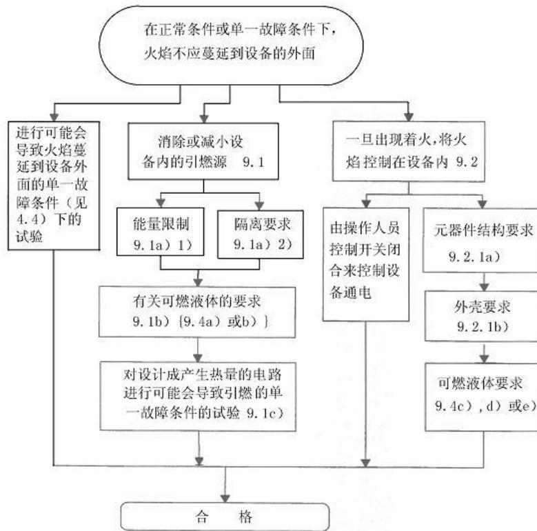
图5 说明防止火焰蔓延要求的流程图
