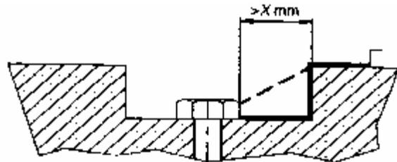
例 10 由于螺钉头与凹槽槽壁之间的空隙足够宽，所以必须考虑该空隙。
