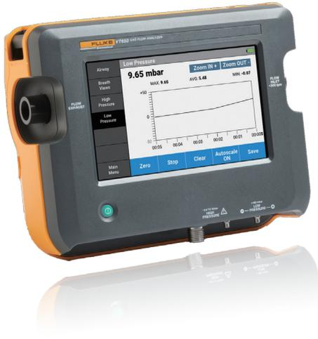
**Fluke Biomedical VT650** 气体流量分析仪集多项功能于一体且方便携带，可准确测试包括呼吸机在内的气体流量设备。
