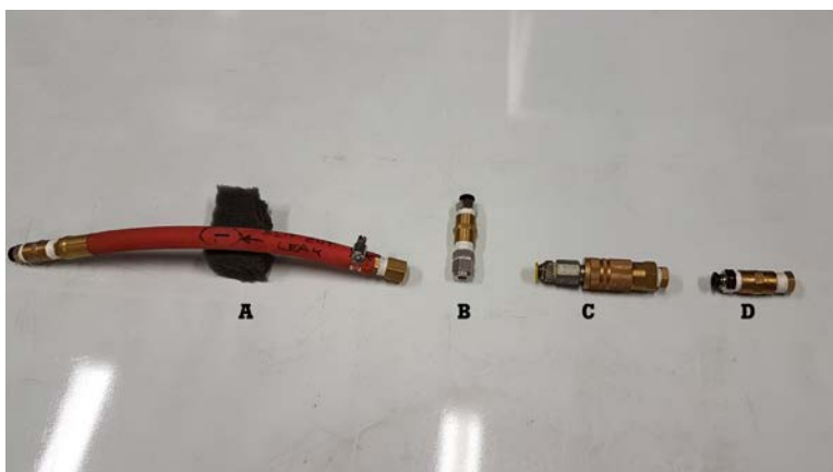
图 5:试验期间研究的四种泄漏类型:软管 (a)、开口端 (b)、快速连接 (c) 和螺纹联接器 (d)。
