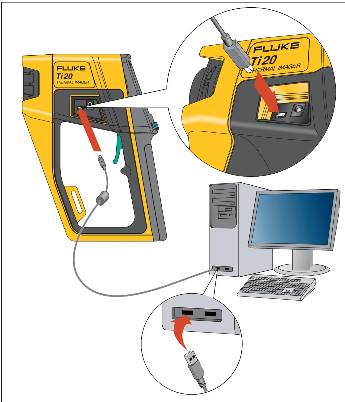
图 1-9. 使用 USB 电缆连接
