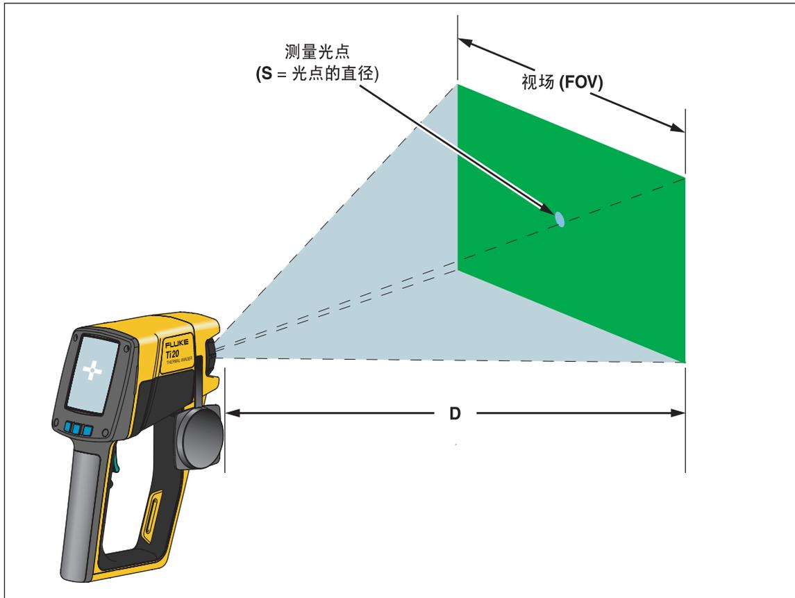
图 2-3. 视场 (FOV) 与测量光点及十字线之间的关系
