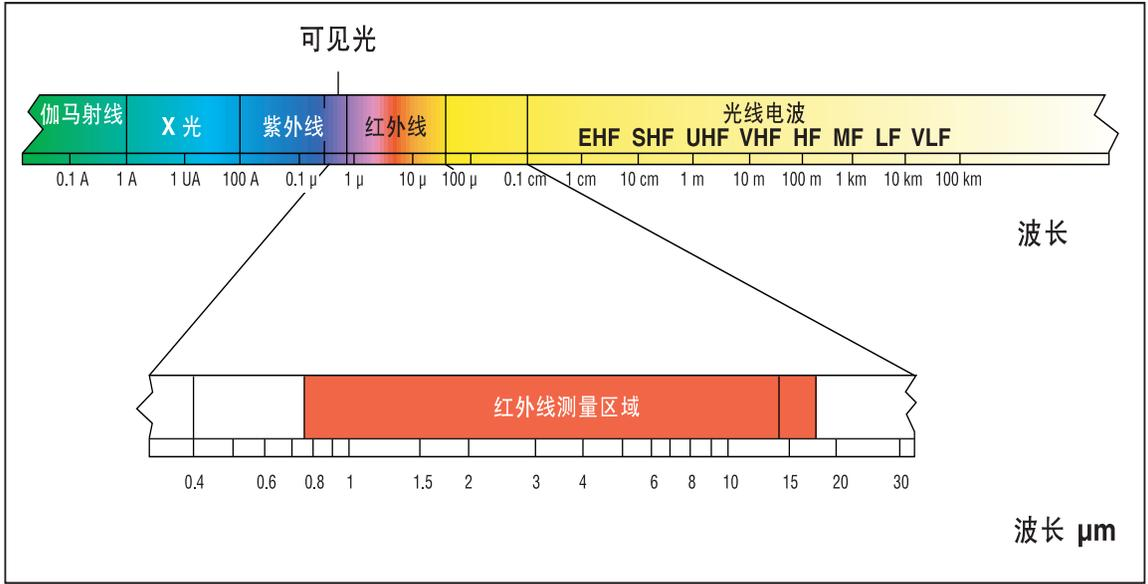
图 B-1. 红外线测量区域
