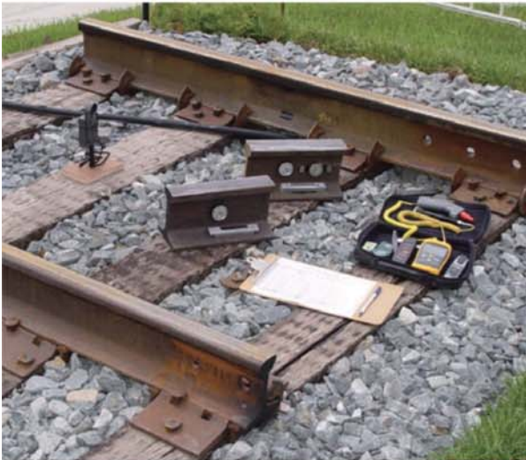
Jim 的小型钢轨测试装置与一个气象站相结合以进行钢轨温度测量，并根据阳光角度、环境温度、风速和相对湿度等对测量值进行比较。
