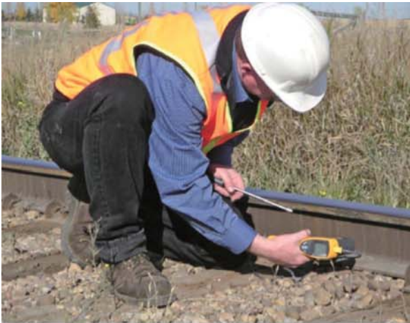
使用红外测温仪进行测试。
