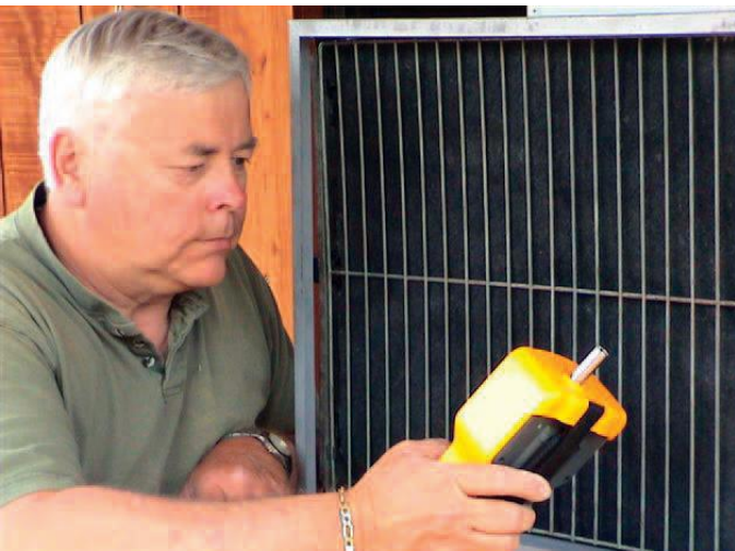
吉姆·约翰逊，设备专家兼讲师，正在空气过滤器旁进行粒子检测分析。
