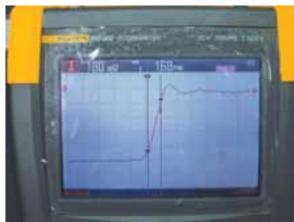
图2. 图中为对两个独立蓄电池组的电池的测试, 说明电池2出现故障(第二条线)。在A点位置, 两组蓄电池都卸载了充电器。电池1的充电情况不变, 但电电池2显示其电压急剧下降。在B点位置, 两组电池同时装裁充电器, 电池2的故障仍然非常明显。
