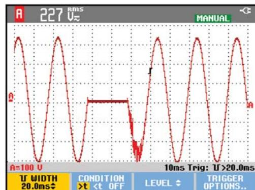
将 ScopeMeter 设置为在时间长于 20 ms 的负向脉冲触发，将检测到电源上丢失的周期。
