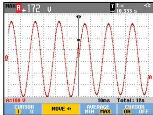
ScopeRecord 显示 UPS 关断时的电压异常。
