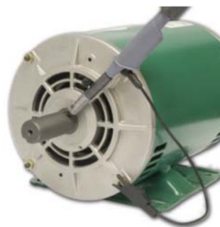
利用 Aegis 轴电压探头测量电机轴电压(感谢 Electro Static Technology 提供图片)
