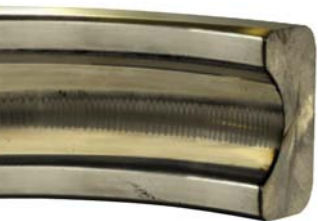
轴承电流造成的轴承套圈凹槽(感谢 Electro Static Technology 提供图片)
